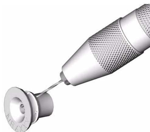
Рис. 2. Прочистка отверстий для компонента В (полимер)
