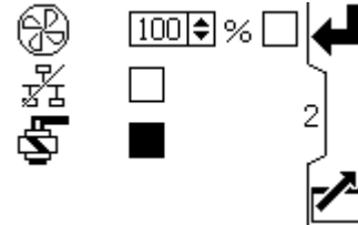
Figure 10 充填ポンプソレノイドの手動制御
